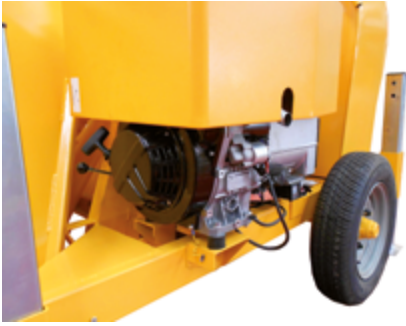
Grupo generador diesel. Diesel generator group. Groupe generateurs diesel.
